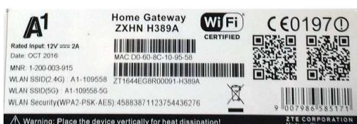
Abbildung Typenschild auf der Modemunterseite
